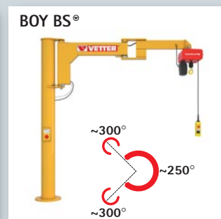
Typenbezeichnung: BOY BS® Tragfähigkeit: 63 – 250 kg Ausladung: 2.000 – 4.000 mm
